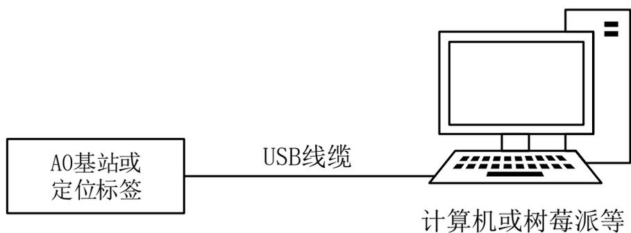
图 5-1 模块连接 PC 示意图
