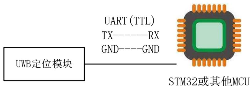
图 4-2 模块 TTL 串行数据接口示意图
