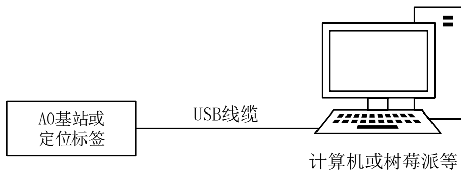
图 6-1 模块连接 PC 示意图
