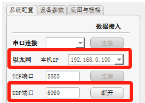
图 6-19 上位机软件连接 UDP
