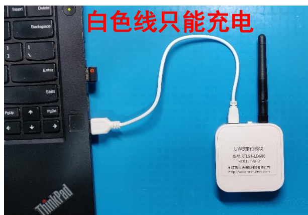
图 6-13 LD150(-I)、LD600(-I)模块连接电脑(只充电)
