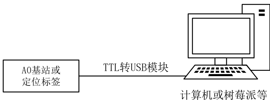
图 6-1 模块连接 PC 示意图
